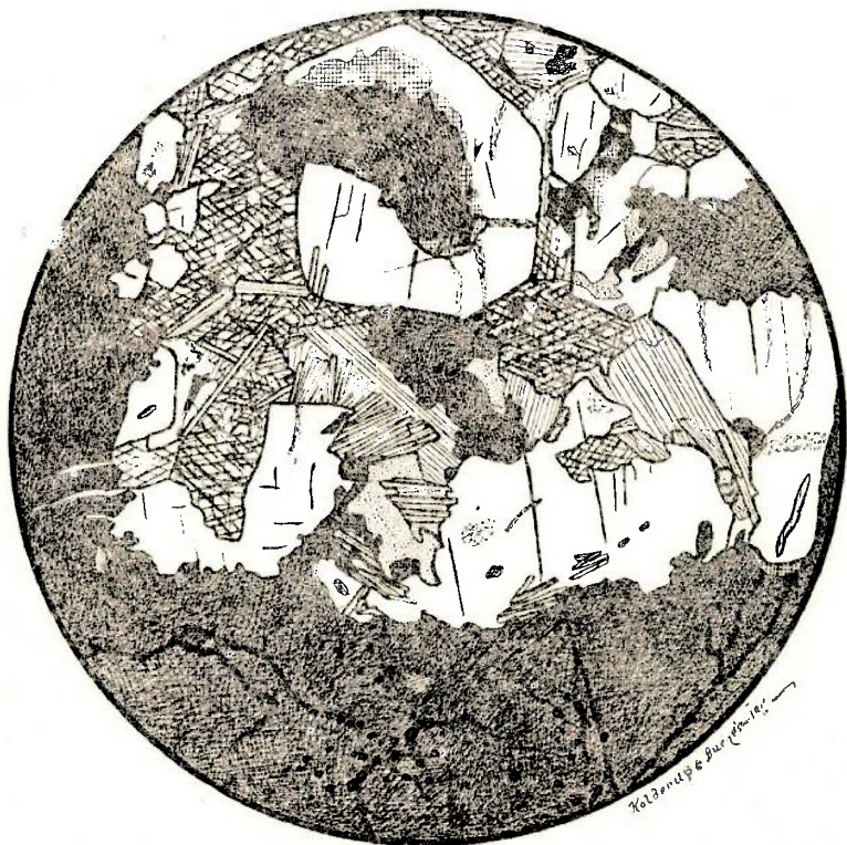
Fig. 12. Ilmenitnorit, Tveitö bei Alværstrømmen. Die dunkle Hauptmasse besteht aus Ilmenit, die feinpunctierten Partien bestehen aus Eisenkies, und mit der regelmässigen rautenförmigen Schraffurung ist Rutil bezeichnet. Die hellen grossen Körner, die z. T. Krystalbegrenzung besitzen sind Granate, die Individuen mit den unter einem Winkel von 124\frac{1}{2} kreuzenden Risse sind Hornblenden und die feingestreiften sind Biotite.
